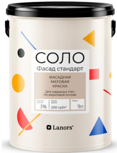
Стирол-акриловый сополимер. Матовая фасадная краска с низким содержанием ЛОС. Краска отличается высоким укрывом и хорошей адгезией к основанию. При нанесении образует равномерную матовую поверхность. Хорошо защищает поверхность от атмосферных осадков. Исключает появление плесени и грибка, не выгорает. Рекомендована к нанесению на фасады.
